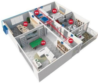
**DLSE + VAV** : gainable à volume d'air variable, cette solution innovante propose une gestion optimale du confort de l'habitat grâce à un contrôle des espaces qui permet d'obtenir la température idéale dans chaque pièce.
